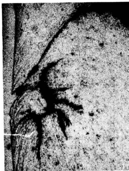
Fot 3.16. 150× HNO 3 -HF Obraz łuski na przekroju poprzecznym blachy ze stali gatunku 08H18N10T: pęknięcia główne oraz drobne pęknięcia przy powierzchni
