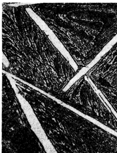
Fot. 4.6. 75× Nital Stop elaza z w glem o zawarto ci ok. 2,5 %C ( eliwo biale): na tle ledeburytu przemienione- go jasne igly cementytu pierwotnego
