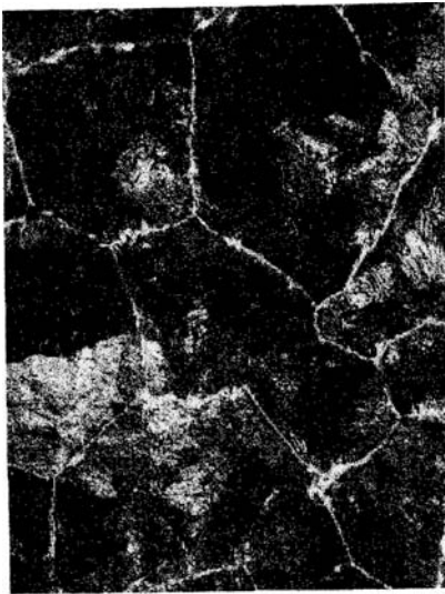
Fot. 6.1. 150× Nital Struktura stali N12 po wy arzaniu normalizuj cym: biała siatka cementytutu wtórnego na granicach ziarn ciemnego perlitu
