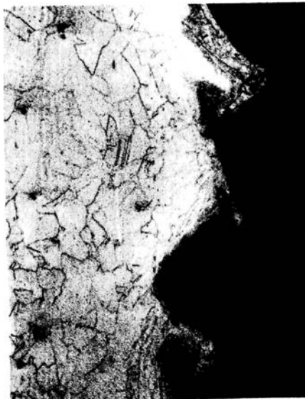
Fot 3.17. 150× HNO 3 -HF Odształcenie plastyczne warstwy wierzchniej blachy ze stali gatunku 08H18N10T w wyniku szlifowania
