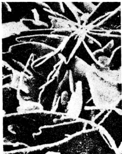
Fot. 5.7. 150× \text{CH}_3\text{CH}_2\text{CH}_3\text{-Br} Grafit płatkowy o ułożeniu rozetkowym. Osnowa została wytrawiona w celu ukazania kształtu przestrzennego grafitu. Mikrofotogra- fia wykonana na mikroskopie skaningowym
