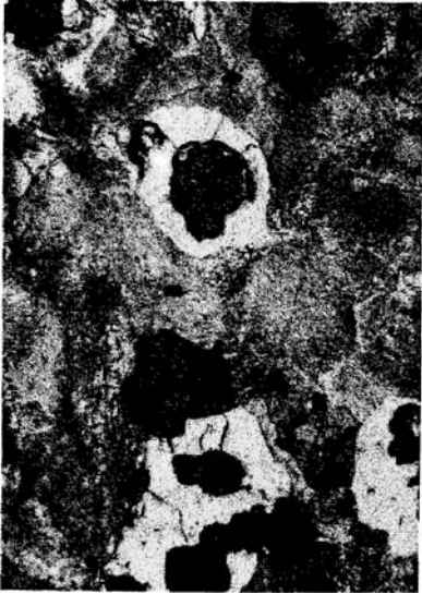
Fot. 5.13. 200× Nital eliwo sferoidalne Zs60003: kuliste wydzielienia grafitu w otoczce ziarn ferrytu na tle perlitu
