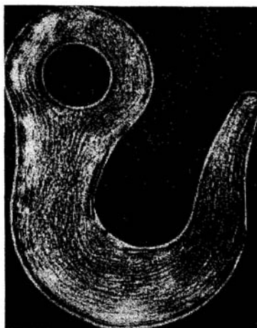
Fot 3.10. 0,3× odcz. Jacewicza Podłużny przekrój kutego haka stalowego: struktura włóknista, otwór uzyskany przez przebicie na gorąco
