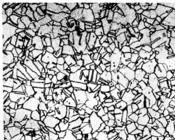
Fot. 10.3. 150× HNO 3 -HF Stal kwasoodporna klasy austenitycznej gat. 1H18N9 przesycona z 1050°C w wodzie: równosiowe, jasne ziarna austenitu o prostoliniowych granicach, z charakterystycznymi utworami bli niaczymi
