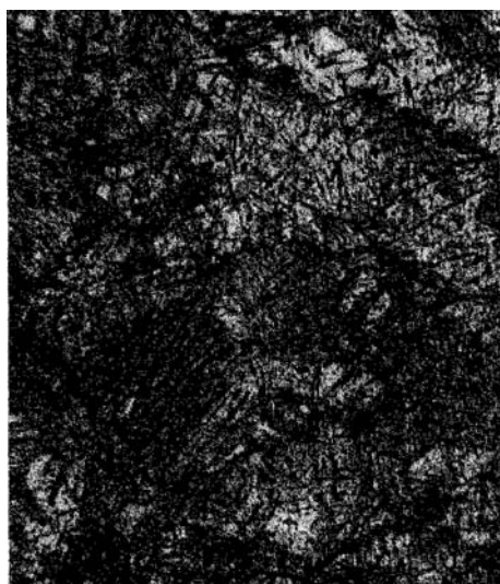
Fot. 7.3. 200× Nital Stal w głowa podeutektoidalna gat. 45, austenitowana w 1000°C, chłodzona z szybkości wi ksz od krytycznej (w wodzie): martenzyt gruboiglasty
