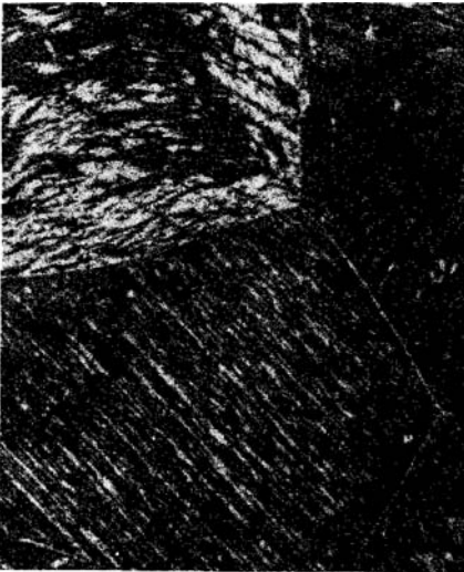
Fot. 13.11. 200× \text{FeCl}_3\text{-HCl} Br z alumiowy CuAl10Fe3Mn2 po zahar- towaniu: mieszanina faz \alpha' i \alpha_2 o iglastym wyglądzie przypominającym martenzyt w stali
