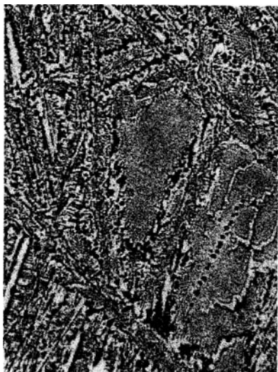
Fot. 4.9. 75× Nital Stop elaza z w glem o zawarto ci ok. 4,3%C ( eliwo białe eutektyczne): ledeburyt przemieniony (pola kropkowane) o budowie dendrytycznej i lady cementytu wtórnego (biała siatka)
