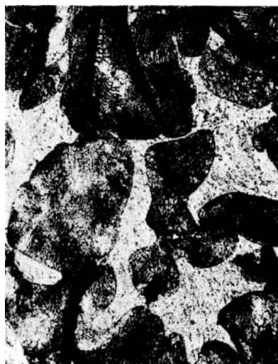
Fot. 5.12. 200× Nital Potrójna eutektyka fosforowa (biała) w postaci siatki na tle perlitu w oliwie szarym ZI300
