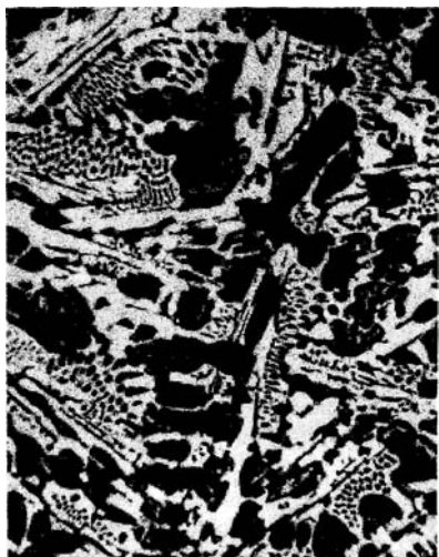
Fot. 5.1. 200× Nital eliwo białe podeutektyczne: kropkowany le- deburyt przemieniony oraz du e, ciemne pola perlitu i jasne wydzielenia cementytu wtórnego
