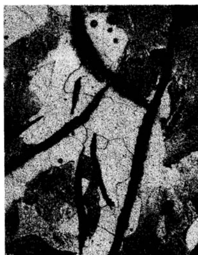
Fot. 5.3. 200× Nital Osnowa ferrytyczno-perlityczna (białe i szare ziarna) z czarnymi wydzieleniami grafitu płat- kowego w eliwie szarym Z1200
