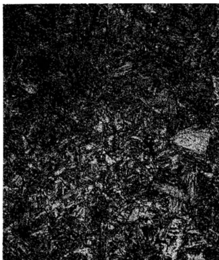
Fot. 7.4. 200× Nital Stal w głowa podeutektoidalna gat. 45, hartowana izotermicznie w 450°C: bainit górny - pierzasty
