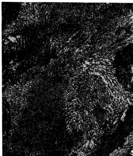
Fot. 7.1. 200× Nital Stal w głowa eutektoidalna, austenitizowana w 770°C, chłodzona izotermicznie do: a) 700°C - mały stopie przechłodzenia - perlit grubodispersyjny, b) 650°C - duży stopie przechłodzenia - perlit drobnodispersyjny
