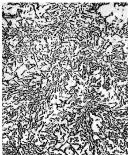
Fot. 14.1. 100× bez trawienia Silumin eutektyczny AK12: gruboziarnista eutek- tyka złożona z iglastych ziaren Si i roztwo- ru (białe tło)
