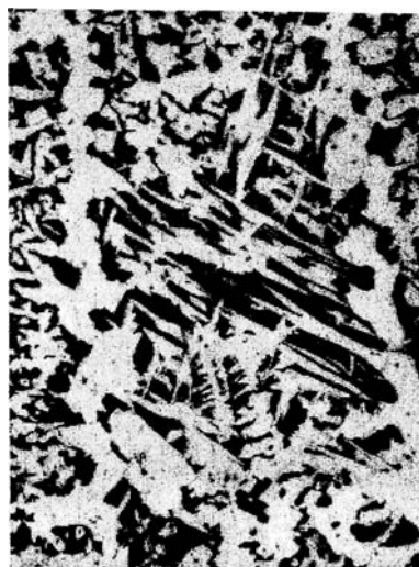
Fot. 4.4. 75× Nital Stop elaza z w glem o zawarto ci 0,4% C (stal gat. 40): perlit z ferrytem (biały) w postaci iglastych kryształów
