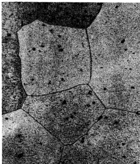
Fot. 10.5. 150× HCl-HNO 3 Stal aroodporna klasy ferrytycznej gat. H25T: gruboziarnisty ferryt stopowy z wydzieleniami w glika M 6 C
