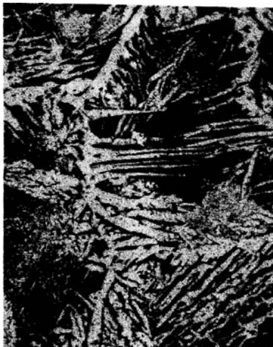
Fot. 63. 150× Nital Struktura staliwa L500 w stanie lanym: ferryt (jasny) + perlit (ciemny), widoczny układ Widmannstättena charakterystyczny dla materiałów przegrzanych
