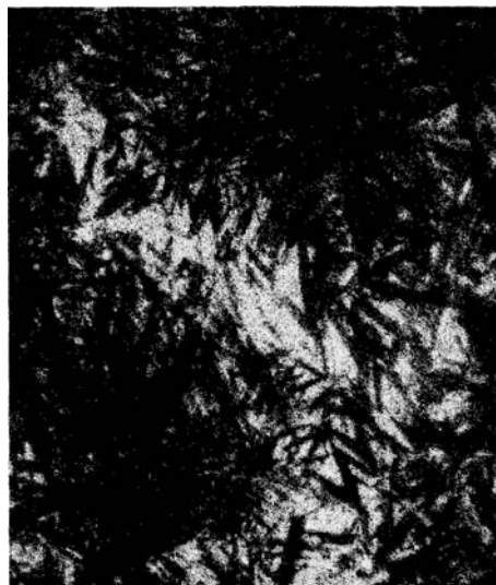
Fot. 7.5. 200× Nital Stal w głowa podeutektoidalna gat. 45, hartowana izotermicznie w 350°C: bainit dolny - iglasty
